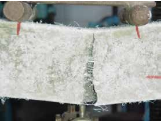
Imagen 2. Ensayo a flexión de panel reforzado con fibras vegetales
