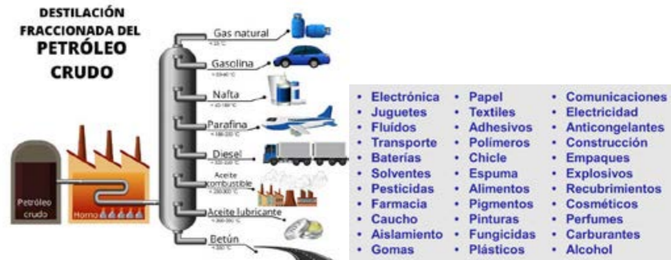
Figura 2. Con la destilación fraccionada del petróleo (imagen izquierda) se obtienen, aparte de los combustibles que mueven al mundo moderno, prácticamente todos los productos de diferentes índoles químicas y funcionalidad (imagen derecha) que la sociedad de consumo requiere para su supervivencia ( https://www.lifeder.com/destilacion-fraccionada/ ).
