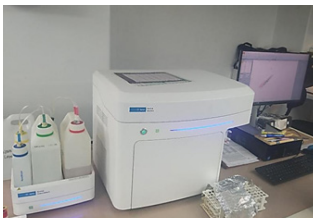
Figura 6. Citómetro de flujo Novocyte Advanteon (Agilent). IDI, UCV. Las señales de dispersión captadas por el citómetro de flujo se utilizan para discriminar las subpoblaciones de células NK
