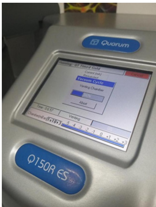
Figura 10. Evaporador de alto vacío de plasma ( Quorum 150R ES ). Unidad de Microscopía Electrónica. Centro de Química. IVIC
