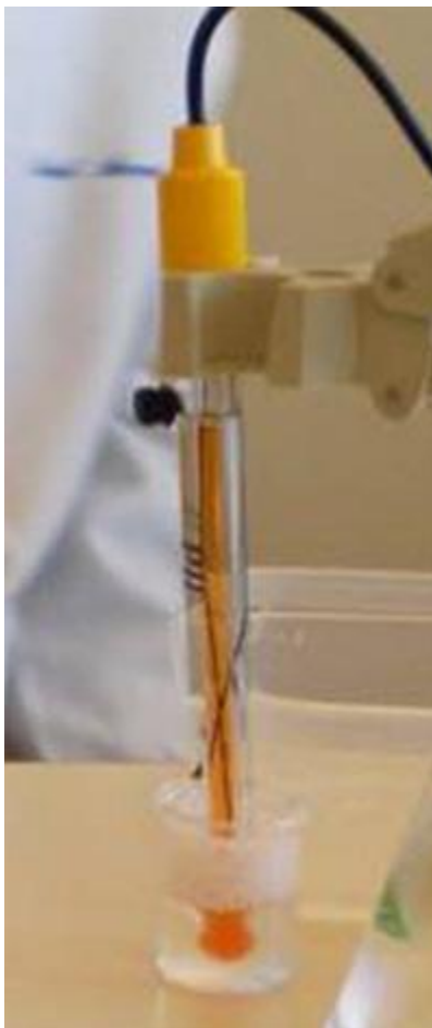
Figura 1 Electrodo de pHmetro o potenciómetro, registrando medición de pH de una muestra de saliva.
