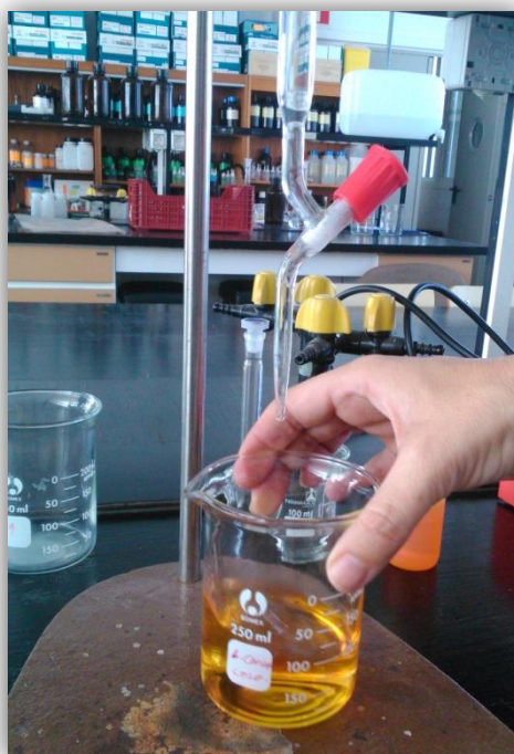
Figura 36. Añadiendo ácido clorhídrico a la muestra de agua con naranja de metilo
