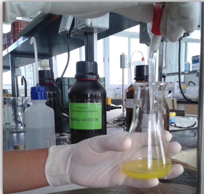
Figura 42. Ensayo de cloruros
