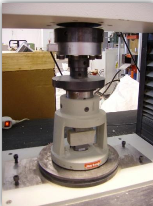
Figura 59. Ensayo a compresión
