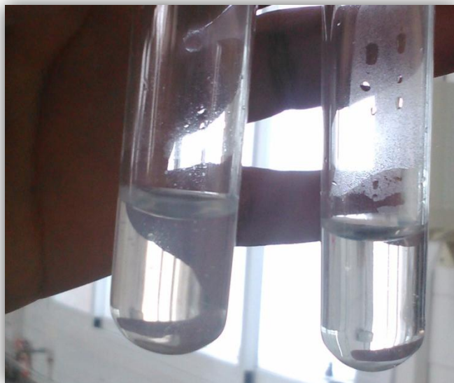
Figura 40. Contraste entre dos muestras, la de la izquierda tiene un tono blanquecino, indicador de presencia de cloruros
