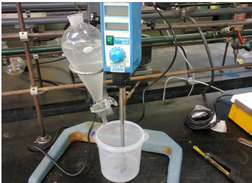
Figura N° 7. Sistema de Incorporación y mezclado de reactivos.
