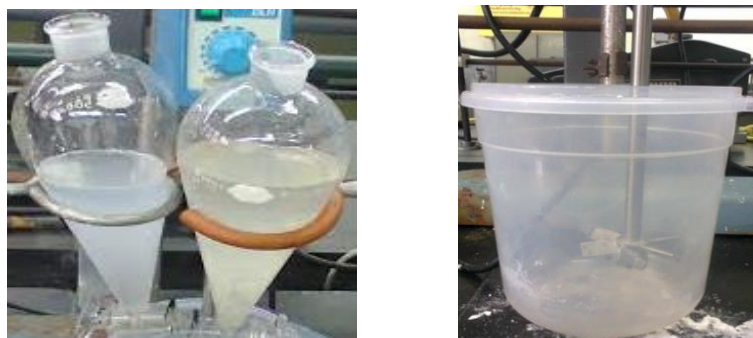
Figura N° 6. Dosificadores, reactor y agitador utilizado para la incorporación y mezclado.
