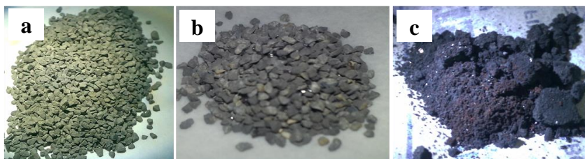
Figura N°. 23. a) Cat. Fresco, b) Cat. Fresco después del barrido de temp. sin “steaming”, c) Cat. Fresco después del barrido de temp. y vel. espaciales (con “steaming” previo).
