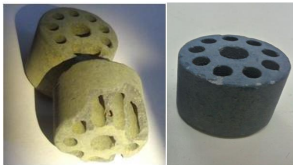
Figura N°. 8. Catalizador de reformado en estado Gastado (izq.) y Fresco (der.).
