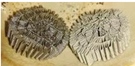
Figura N°. 34. Estructura de acero inoxidable impregnada de catalizador por wash-coating (der.) y sin impregnar (izq.).
