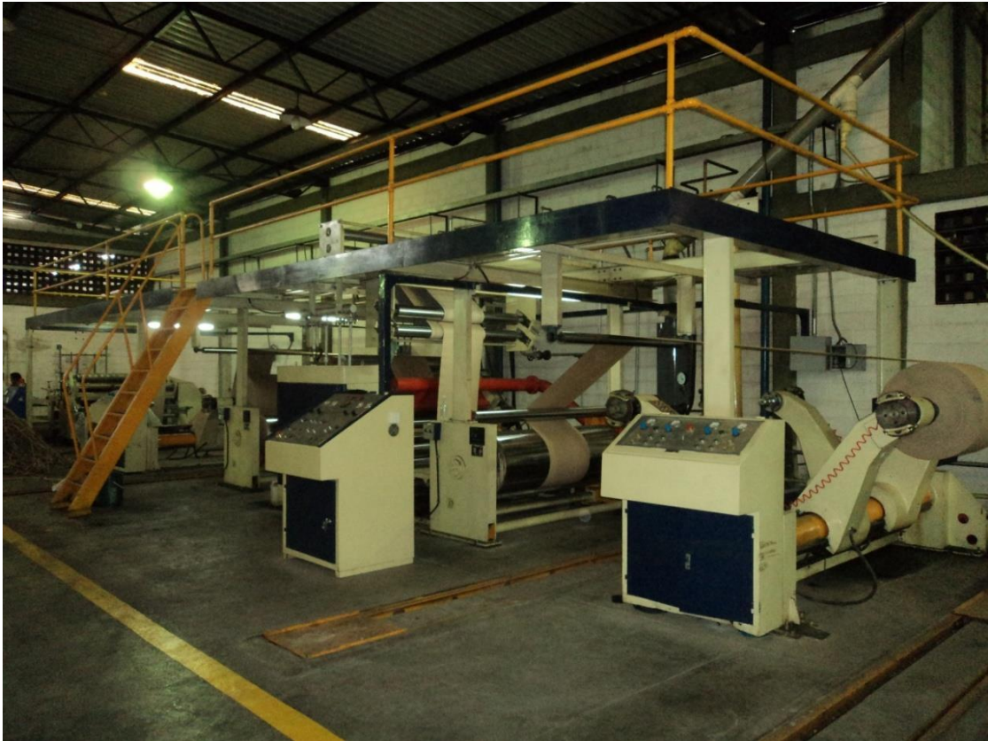
Figura 8. Línea de cartón micro corrugado de simple faz, Mod MF-1600. (Las Autoras, 2013)
