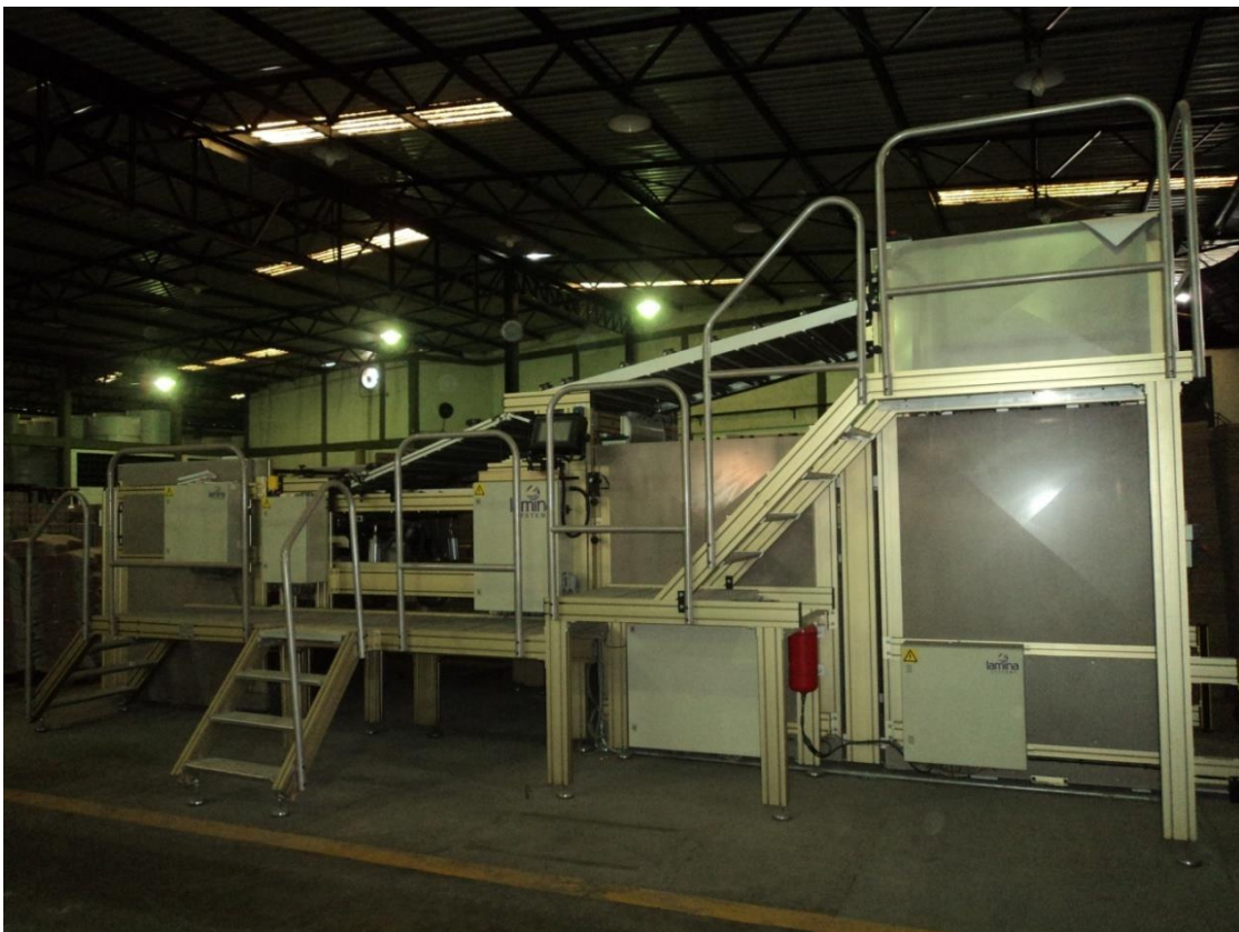
Figura 4. Laminadora automática 1116 FA 1600/8000. (Las Autoras, 2013)
