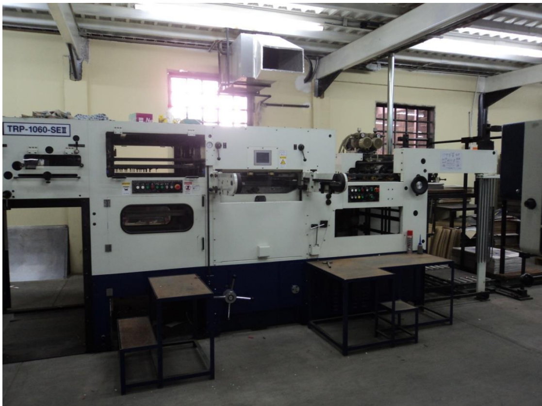
Figura 3. Troqueladora SANWA Modelo TRP 1060 SE II. (Las Autoras, 2013)
