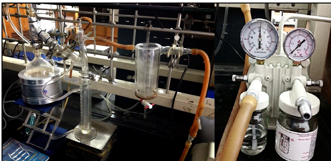
Figura N° 09. Sistema de deshidratación de emulsiones agua/crudo al vacío.
