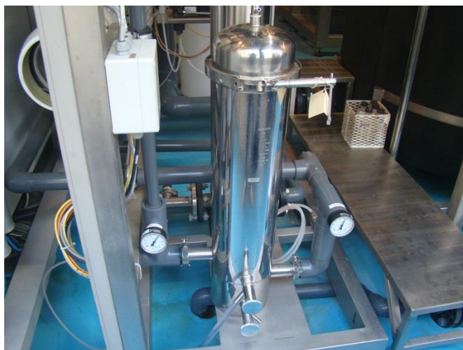
Figura N°. 18. Filtro de 5 µm.
