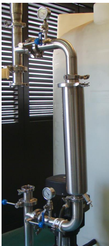
Figura N°. 17. Filtro de 20µm
