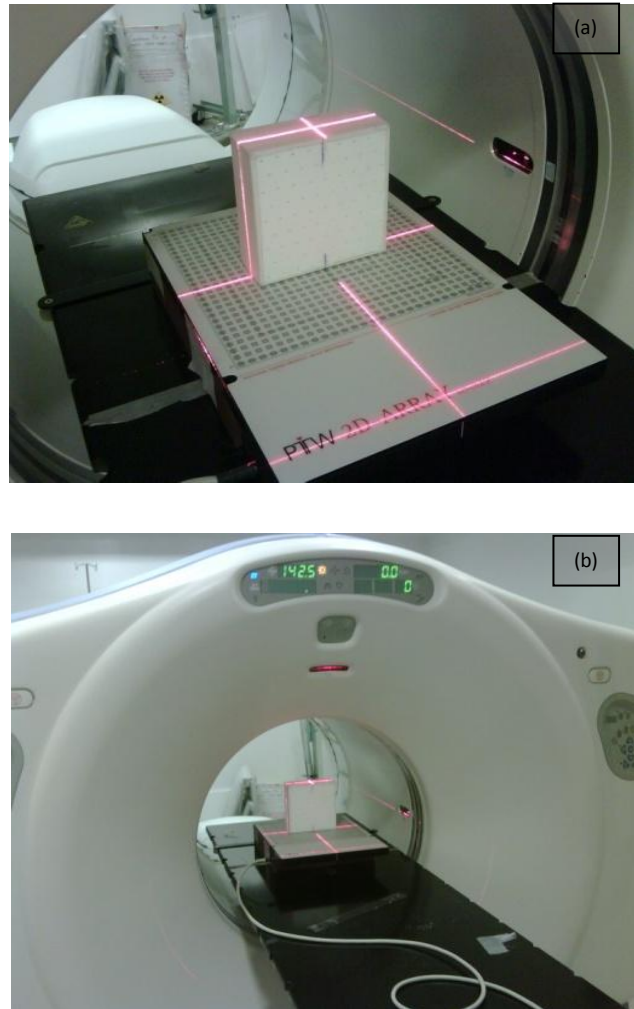
Figura 18.- Técnica TC: (a) Alineación de centros equipo - montaje (b) Unidad de simulación de maniquí (PET - CT).
