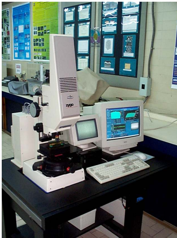
Fig. 34. Perfilómetro utilizado para determinar las rugosidades de las probetas y especímenes.
