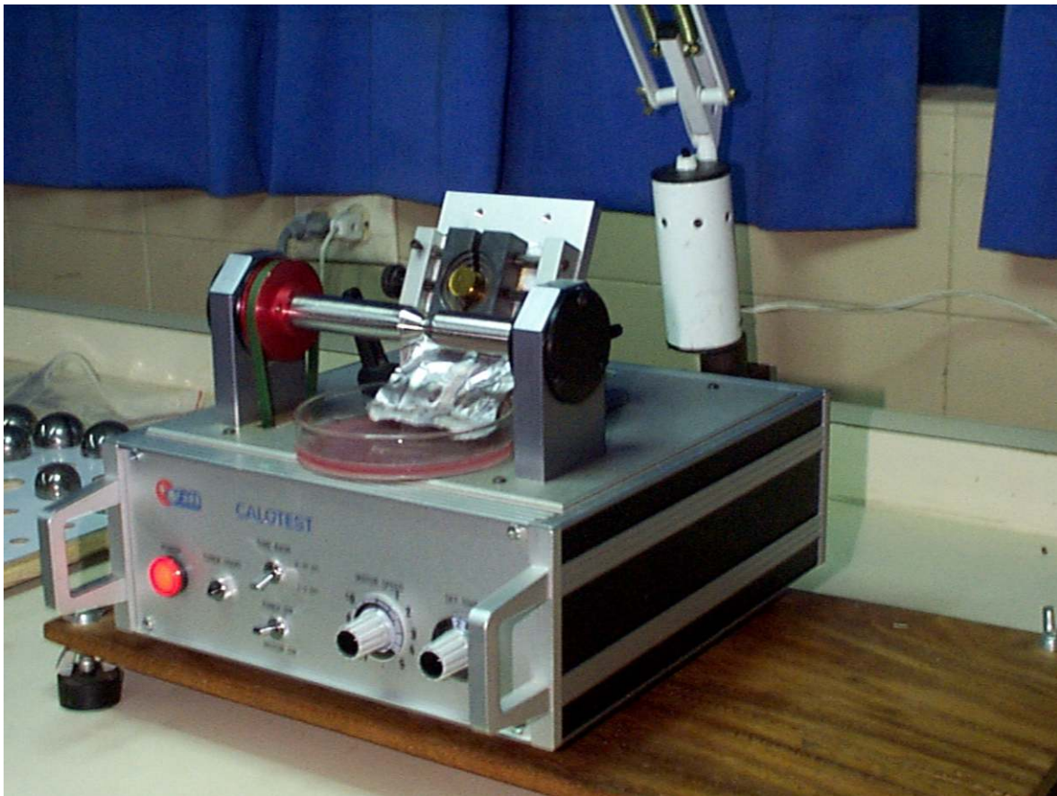
Fig. 35. Equipo de ensayo de calota esférica utilizada para determinar el espesor de los recubrimientos.
