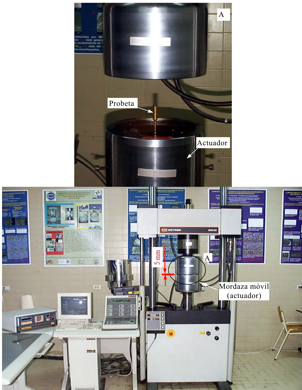
Fig. 37. Fotografía de la máquina utilizada para realizar los ensayos de tracción. (A) detalle del montaje de las probetas.
