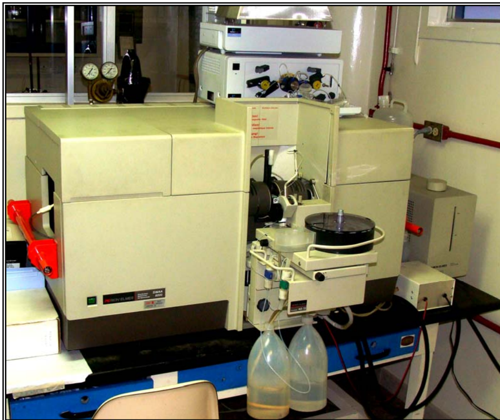
Figura 5. Espectrómetro de absorción atómica con atomización electrotérmica marca Perkin Elmer, modelo SIMAA 6000
