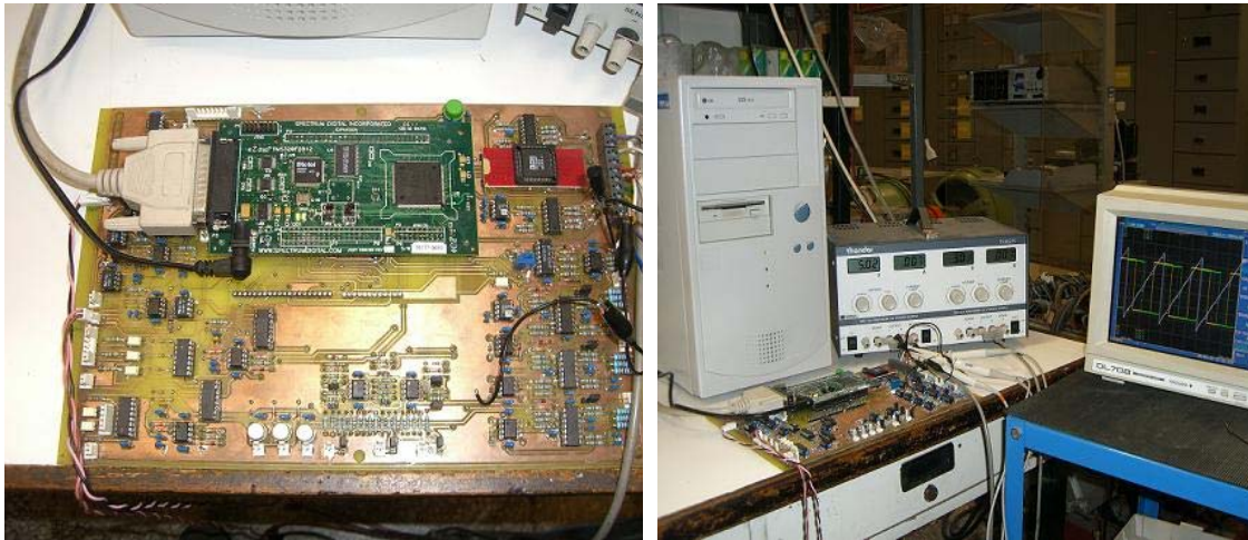
Fig. 4.21. Struttura sperimentale per implementare il VTO
