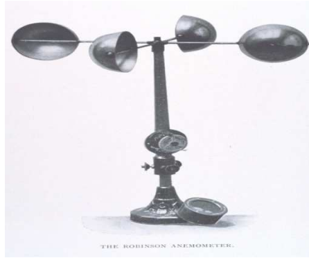
Figura 1.5: Anemómetro tipo taza semiesférica inventado.
