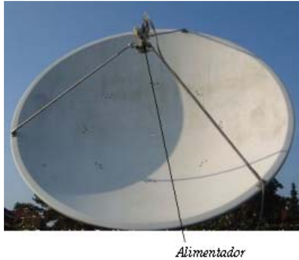
Figura 2.4 Posición del alimentador en una antena terrestre
