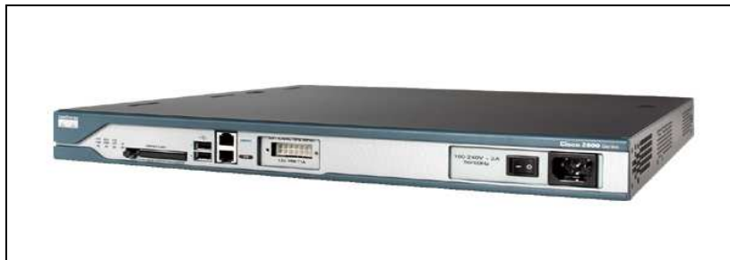
Figura 4-5: Vista frontal de un Router Cisco 2811.
