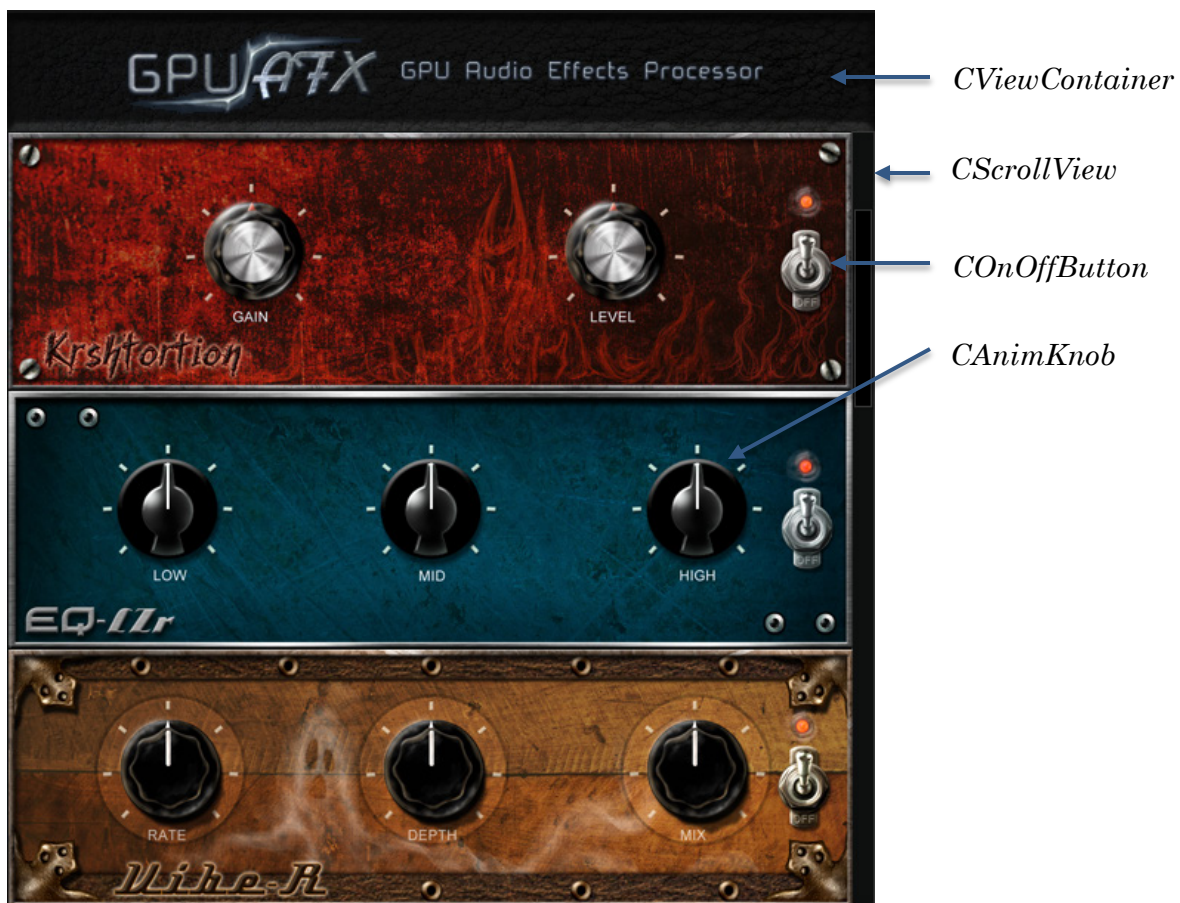
Figura 3.9: Contenedor de efectos del plugin GPUAFX y sus clases de GUI asociadas.
