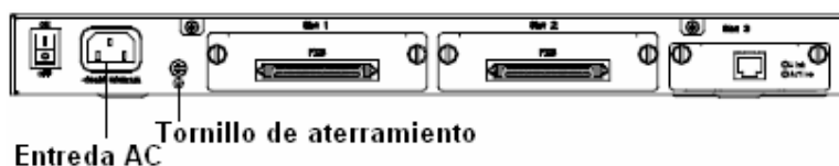
Figura 1. Tornillo de aterramiento en IAD132E.
