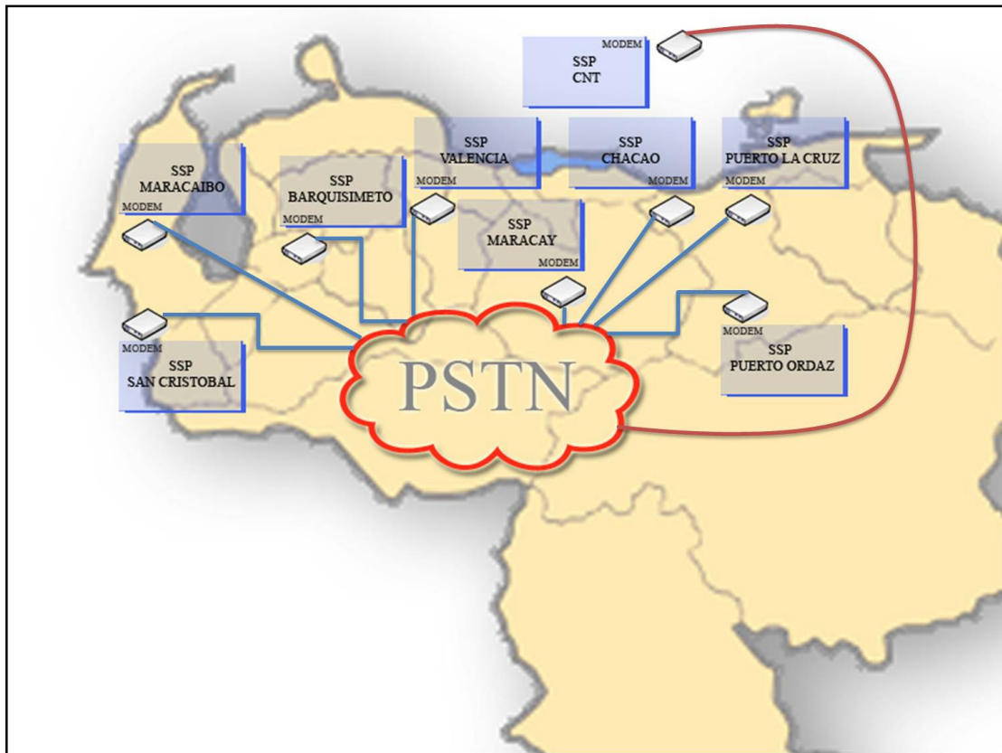
Figura 20: Esquema de interconexión de los nodos SSP
