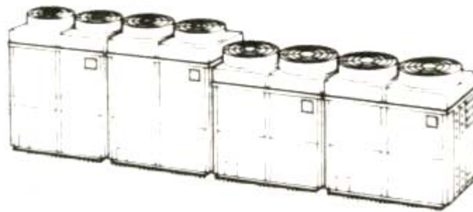
Figura 4.12.- Diseño modular de las unidades exteriores.
