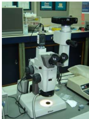
Fig.II.9. Lupa Estereoscópica Marca Nikon, modelo SMZ-U
