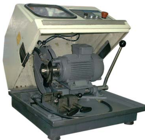
Fig.II.17. Máquina Cortadora de disco abrasivo Marca Buehler, modelo Abrasimet II
