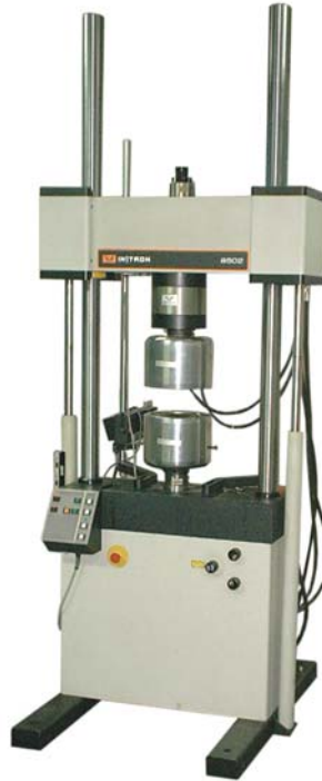
Fig.II.15. Máquina Universal de Ensayos Mecánicos Servohidráulica. Marca Instron, modelo 8502
