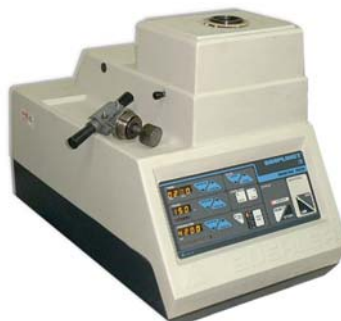
Fig.II.6. Equipo de montaje Marca Buehler, modelo Simplimet II
