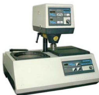
Fig.II.7. Equipo para desbaste Marca Buehler, modelo Ecomet 4
