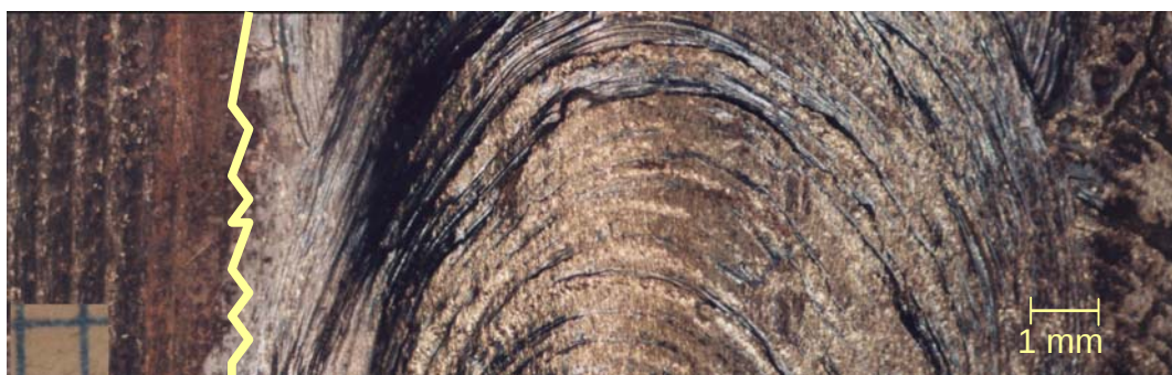
Fig.III.19. Macrografía de la zona donde falló la probeta como se muestra en la Fig III.18
