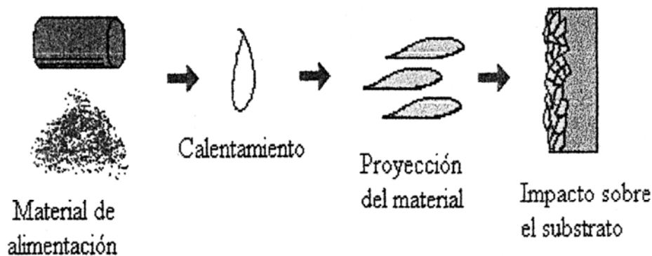
Fig. 6.- Pasos elementales en un proceso de termo-rociado [23] .
