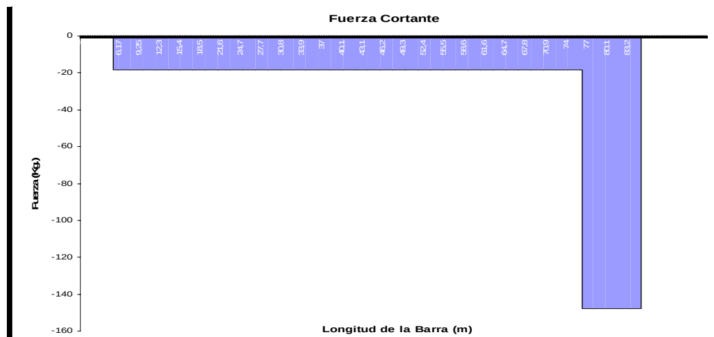
Figura 53. Gráfico de fuerza cortante del eje de palanca.
