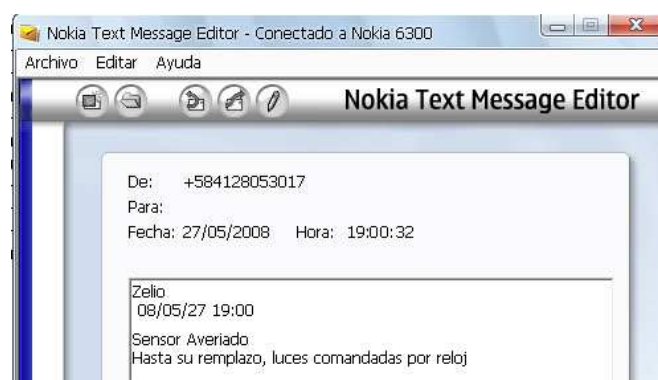
Figura 4.12: Mensaje recibido indicando la falla del sensor
