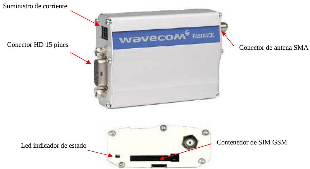
Figura 2.4: Modem GSM de comunicación Fastrack M1306B
