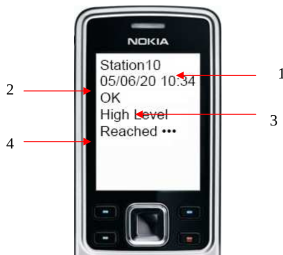
Figura 2.5: Estructura de un mensaje de alarma sin confirmación
