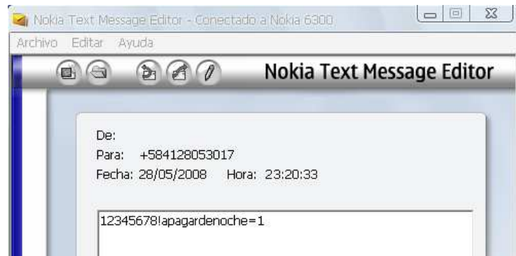
Figura 4.14: Mensaje enviado para el apagado de lámparas
