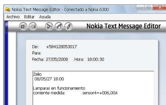
Figura 4.10: Mensaje recibido al encenderse las lámparas mediante el sensor fotoeléctrico
