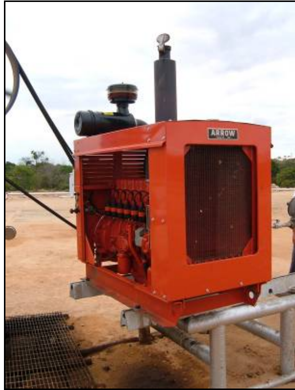
Fig. 17.- El motor Arrow VRG330 es la principal fuerza motriz de los pozos por BCP del AMS.
