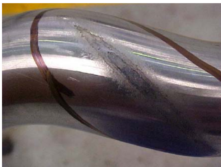
Fig. 35.- Sección desgastada del rotor de la BCP del pozo ES-451.
