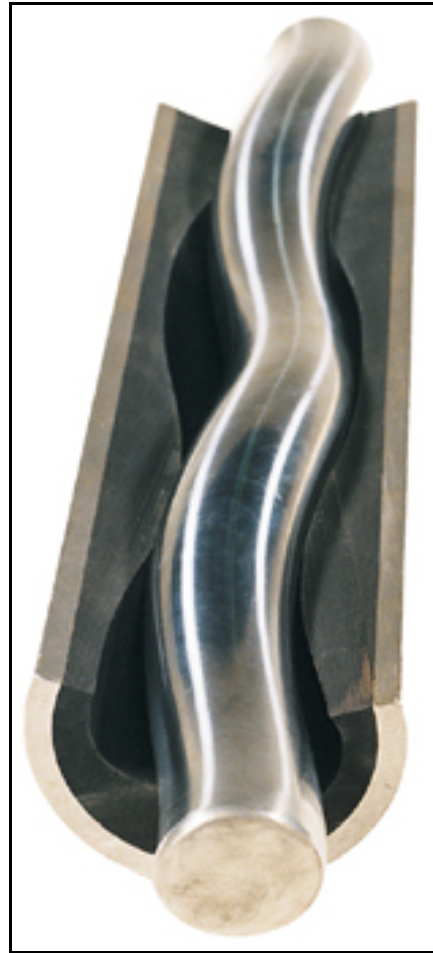
Fig. 5.- Rotor y Estator, componentes básicos de la BCP.
