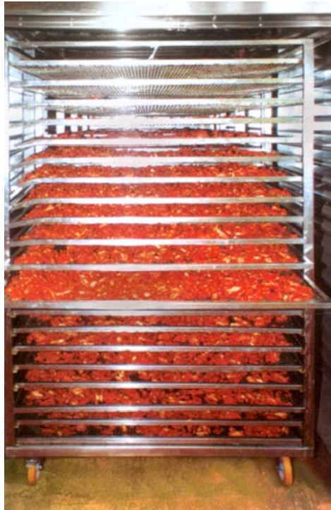
Gráfico 4.14 Distribución de la Materia Prima en las Bandejas de los Carros del Secador de Túnel
