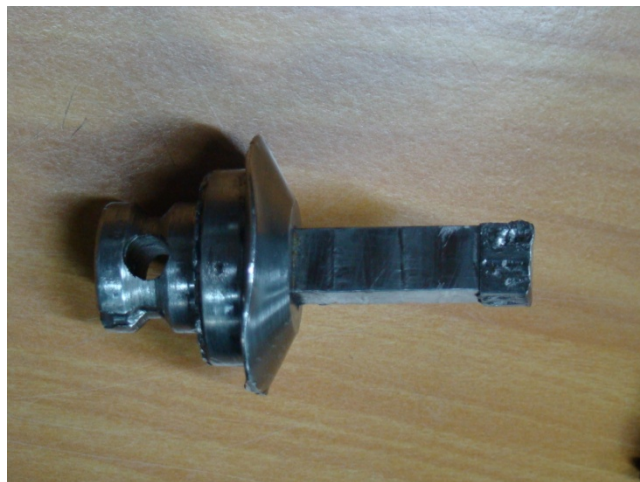
Anexo J, Colapso del Primer Punzón de Extrusión.
