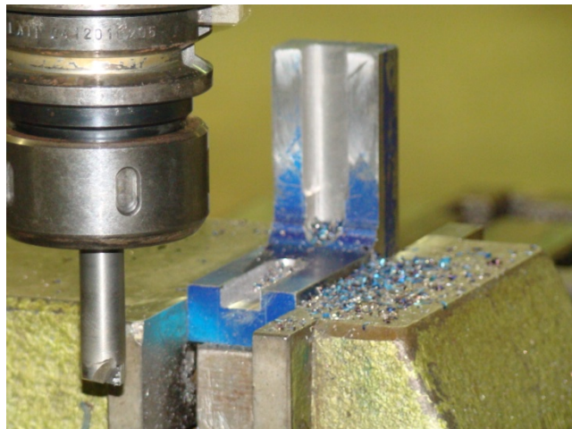
Anexo W , Fresado del Canal de Entrada.
