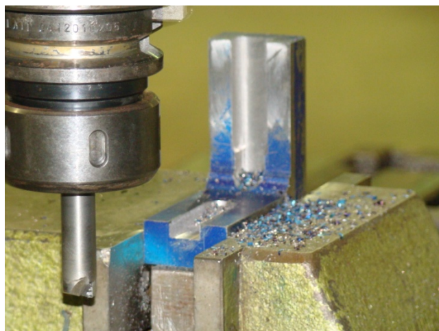
Anexo W , Fresado del Canal de Entrada.
