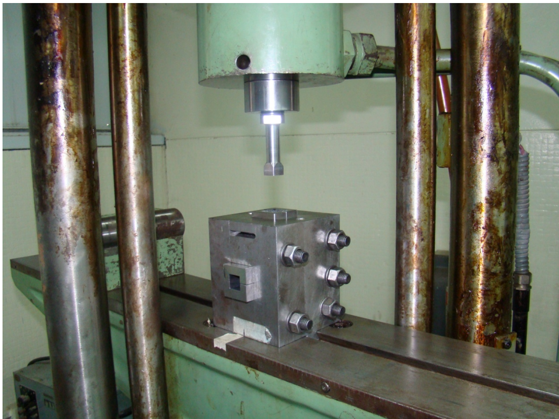
Anexo AA, Conjunto Completo Armado de la Matriz de Extrusión en la Máquina de Ensayos Universales Losenhausen.
