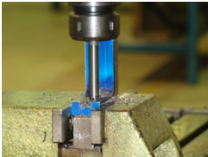
Anexo U , Fresado del Canal de Salida.
