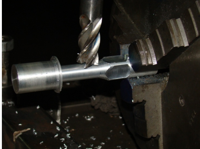
Anexo P, Fresado de la Cabeza del Punzón.
