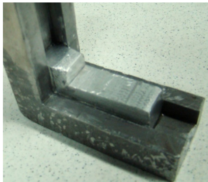
Figura 3.2 Extrusión parcial de Al-6063 T6 en la matriz ECAE.
