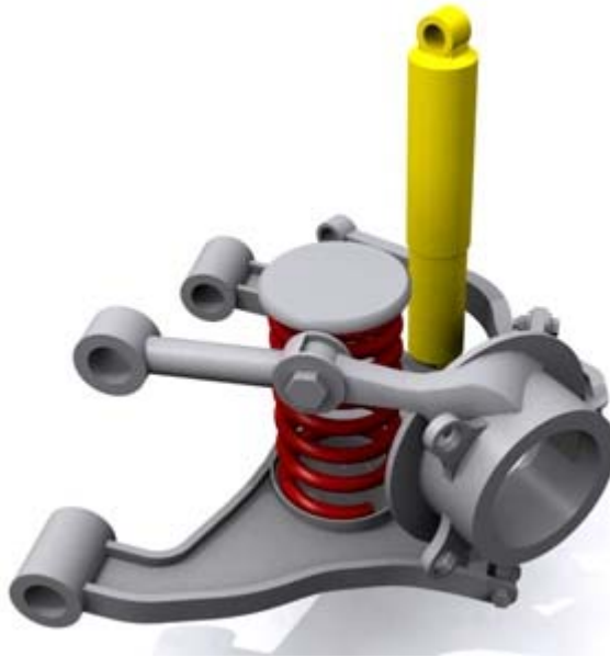
Fig. 3.7 Esquema Multibrazo. (Fuente: www.carbibles.com , 2007)
