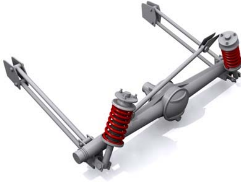
Fig. 3.11 Esquema de cuatro barras con barra Panhard. (Fuente: www.carbibles.com , 2007)
