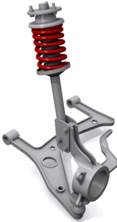
Fig. 3.5 Esquema McPherson. (Fuente: www.carbibles.com , 2007)
