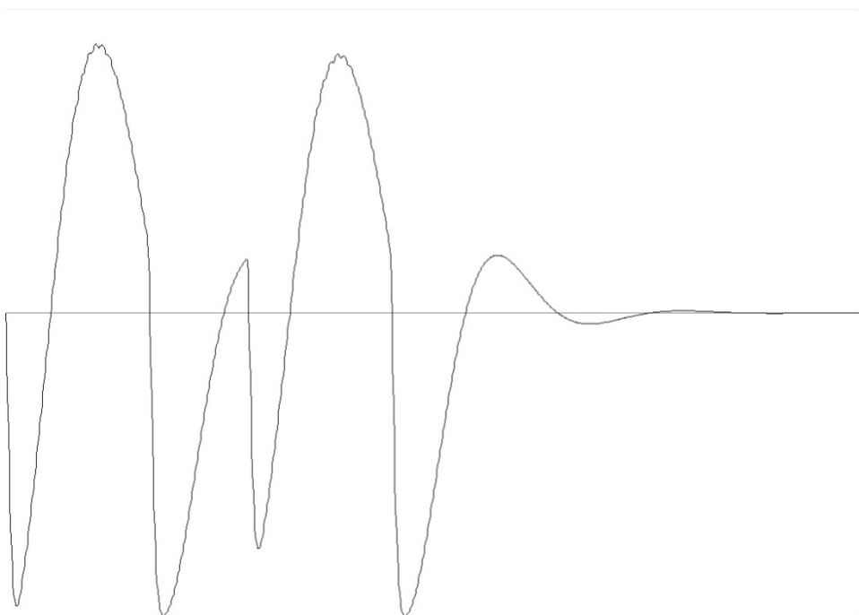
Fig. 7.8 Aceleración vertical del cuerpo en función del tiempo, vehículo base. (Fuente: Elaboración propia, 2008)
