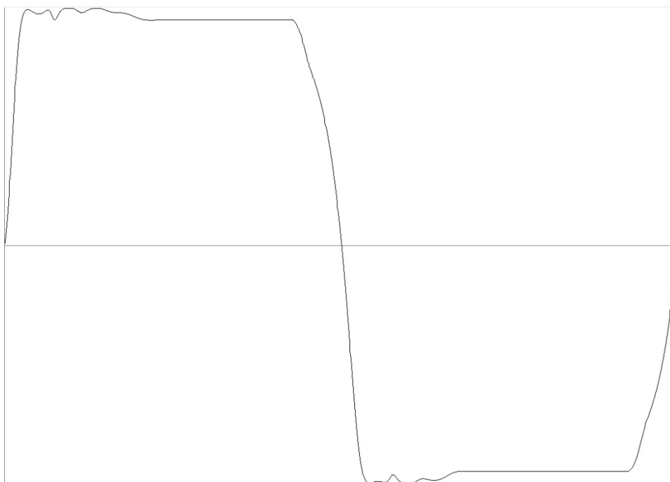
Fig. 7.16 g's centrípetas del vehículo en función del tiempo, vehículo base. (Fuente: Elaboración propia, 2008)
