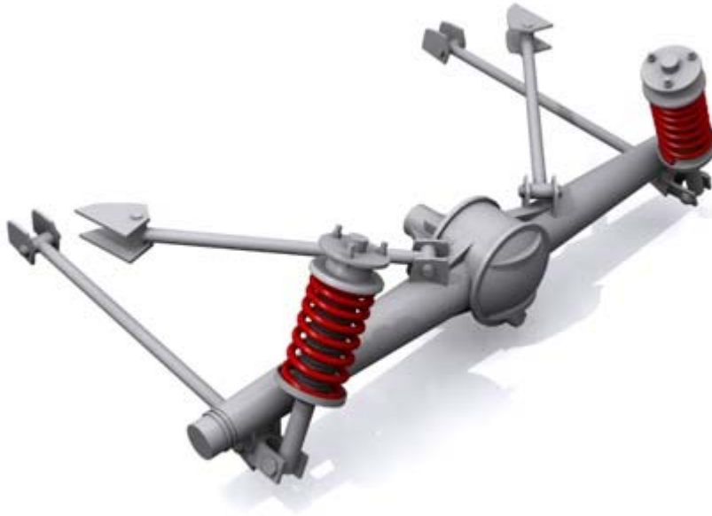
Fig. 3.10 Esquema de cuatro barras. (Fuente: www.carbibles.com , 2007)
