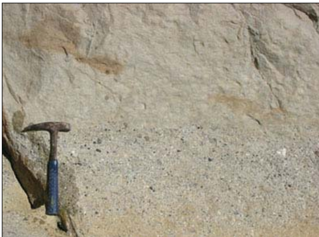
Ilustración 38. Caliza con nivel conglomerático (CA-CO6). (Tomado de Graterol y Orihuela, 2004)
