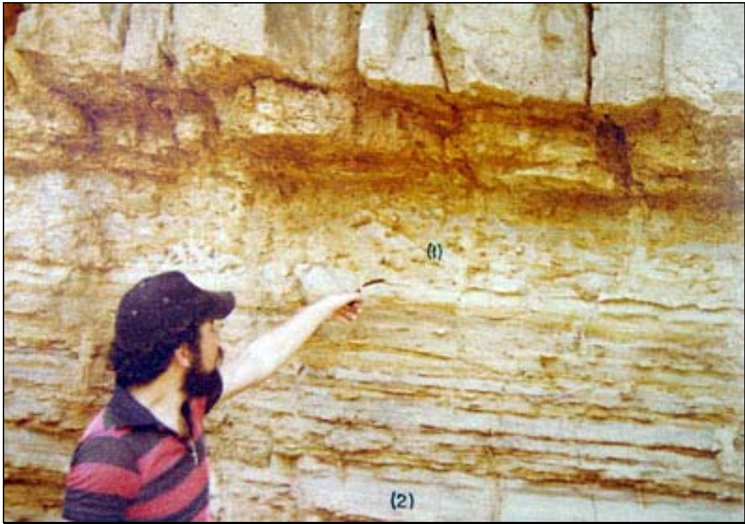
Ilustración 20. Huellas de gusanos y laminación paralela en lutitas de la Formación San Luís. Caserío La Tabla. Rumbo N60E. Tomado de Sandia, 1981.
