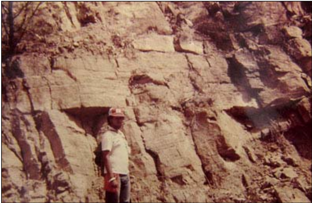
Ilustración 67. Secuencia de areniscas de grano fino a mediodo la Formación Socorro. Carretera hacia Chuchure, rumbo N28E. (Tomado de Esteves y Villalta, 1989)
