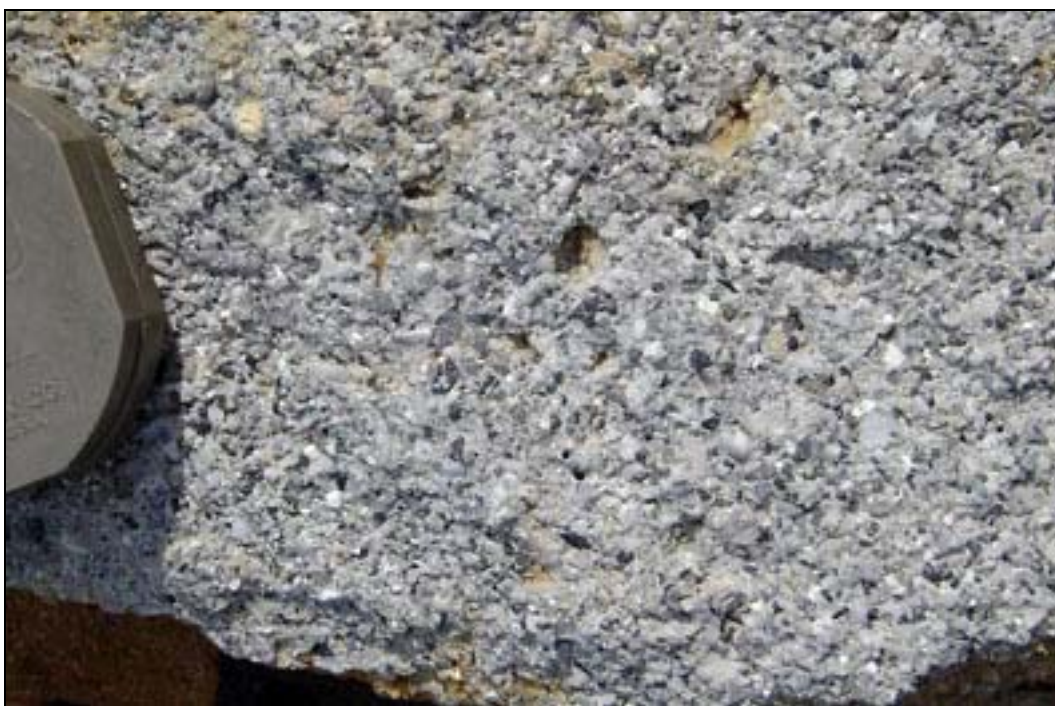
Ilustración 48. Detalle de conglomerado "sal y pimienta" de la Formación Guarabal. (Silva)
