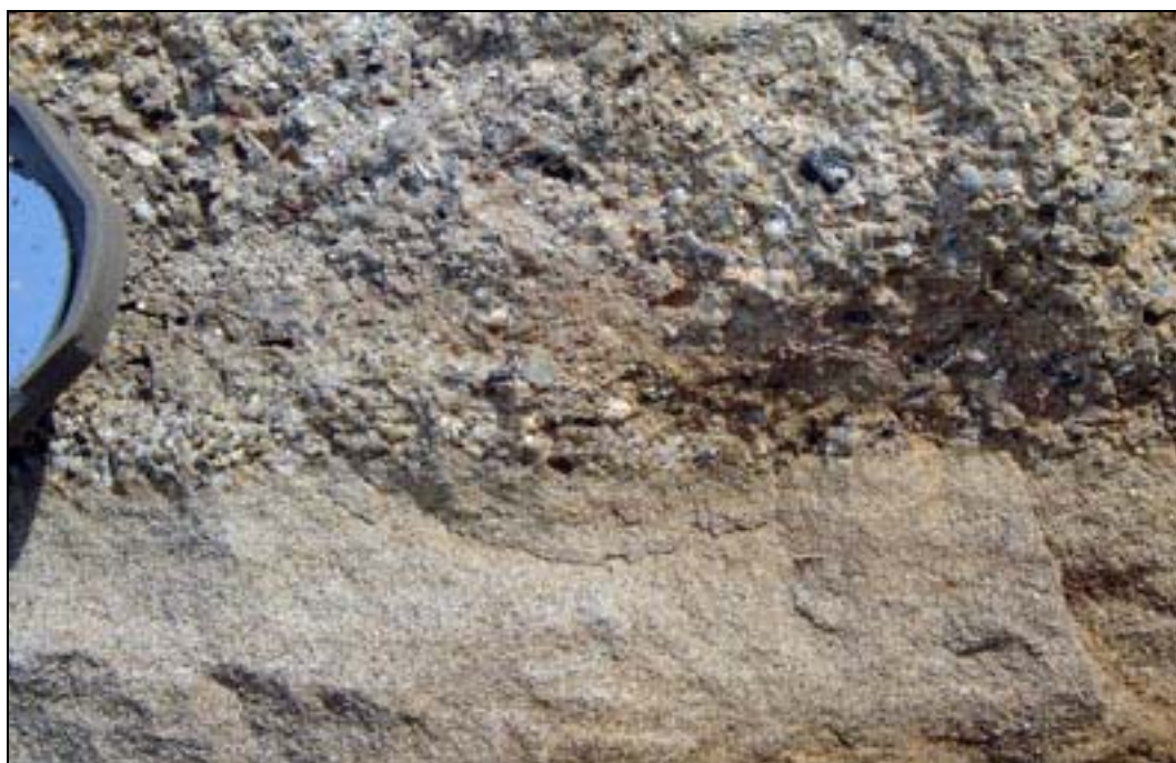
Ilustración 53. Detalle de arenisca de la Formación Guarabal con nivel conglomerático. (Silva)
