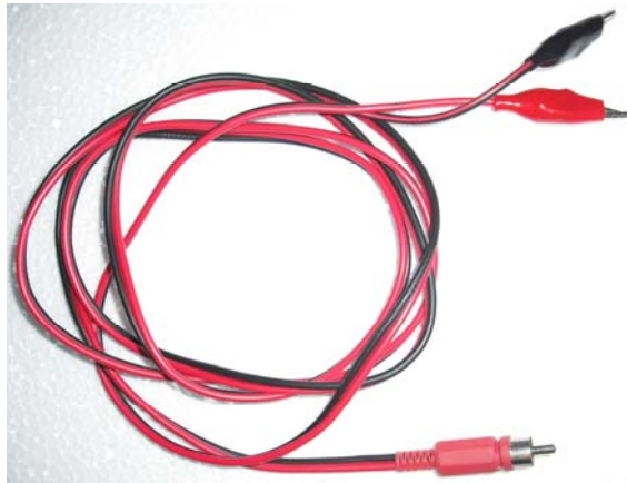
Figura 4.8. Cable N° 18 Negro- Rojo, terminales: RCA - caimán
