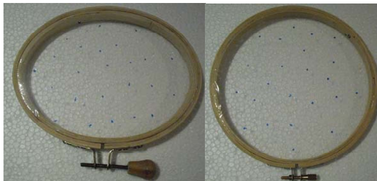
Figura 4.13. Aros para ensayos de geometrías circulares y elípticas. Fuente: el autor.
