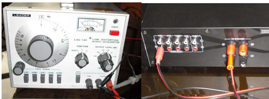
Figura 4.30. Conexiones del generador de señales y el amplificador. Fuente: el autor.
