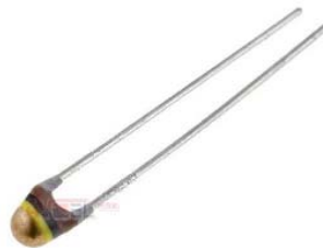
Figura 17. Termistor NTC utilizado en el Sistema
