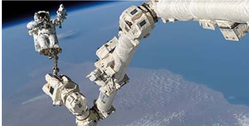
Figura 2.12. Brazo robótico utilizado en el transbordador espacial Columbia
