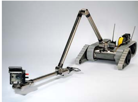
(a) El PACK BOT es un robot de gran resistencia y agilidad.
