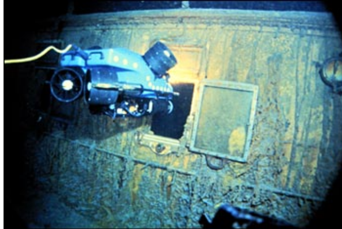
Figura 2.14. Robot de exploración submarina Jason Jr.
