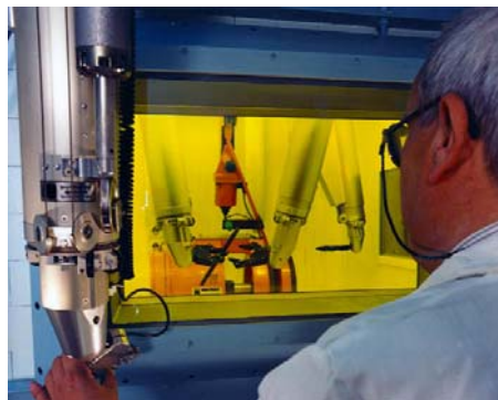
Figura 2.2. Sistema tele-manipulador del tipo “maestro-esclavo” usado en la actualidad.
