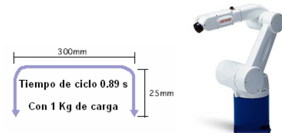
Figura 8.2. Tiempo de ciclo para un robot Denso de la serie VM.
