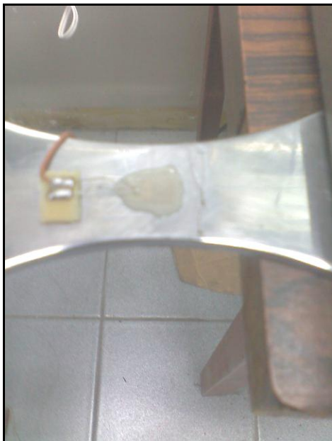
Figura 2.4: Detalle de la colocación de una galga extensiométrica sobre la superficie (una de las caras) de la probeta empleada para ensayos de fatiga.
