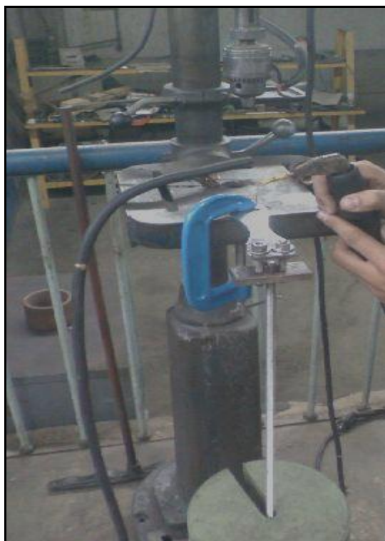
Figura 2.3: Contaminación de probetas de acero ASTM A36 con incrustaciones de cobre realizadas por un proceso de soldadura un cable de cobre desnudo de 2mm de diámetro.
