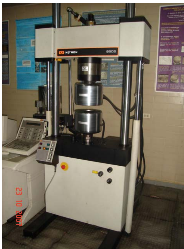
Figura N° 34, Máquina de Ensayo de tracción INSTRON modelo 8502
