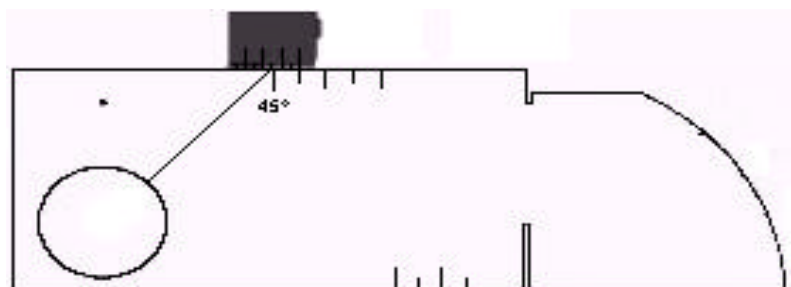
Fig. A-1.2 Angulo real del palpador.
