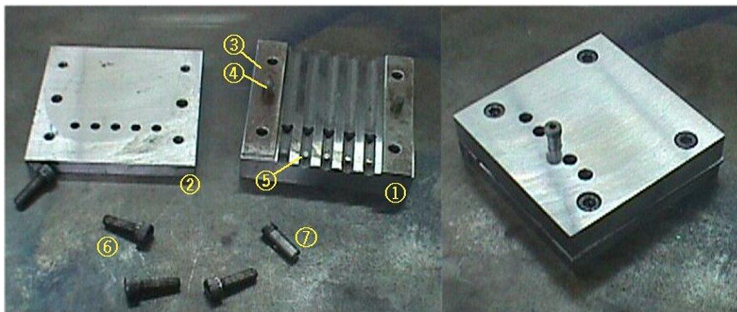
Figura 2-6: Utillaje para agujero piloto en clavos rectos. 1) Tapa, 2) Base, 3) Pletina, 4) Pin guía de ajuste de la base, 5) Pines tope, 6) Tornillos M6 tipo Allen y 7) Bocinas.
