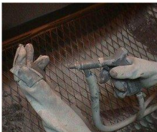
Figura 4-6: Sand Blasting en las probetas del Grupo 1 (Véase también Apéndice 4 Figura A4-2)
