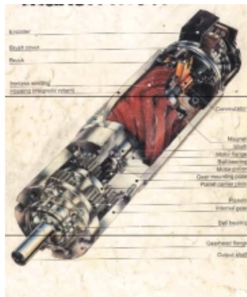
Figura 3.11. Esquema de motor DC seccionado con indicación de sus distintos componentes.[4]
