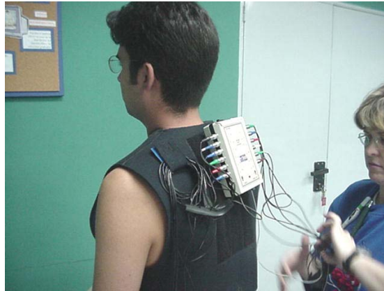
Figura 4.11. Colocación del receptor para electromiografía.
