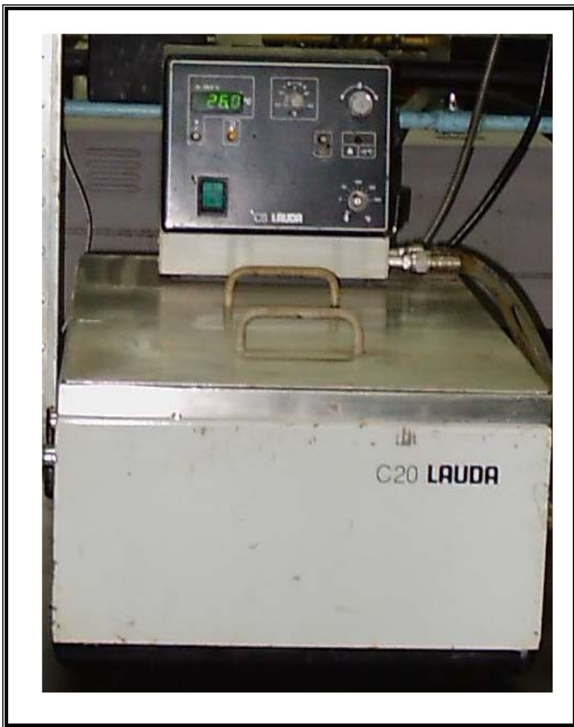
Imagen 5. Baño Termostatizado. Fuente: Autor.
