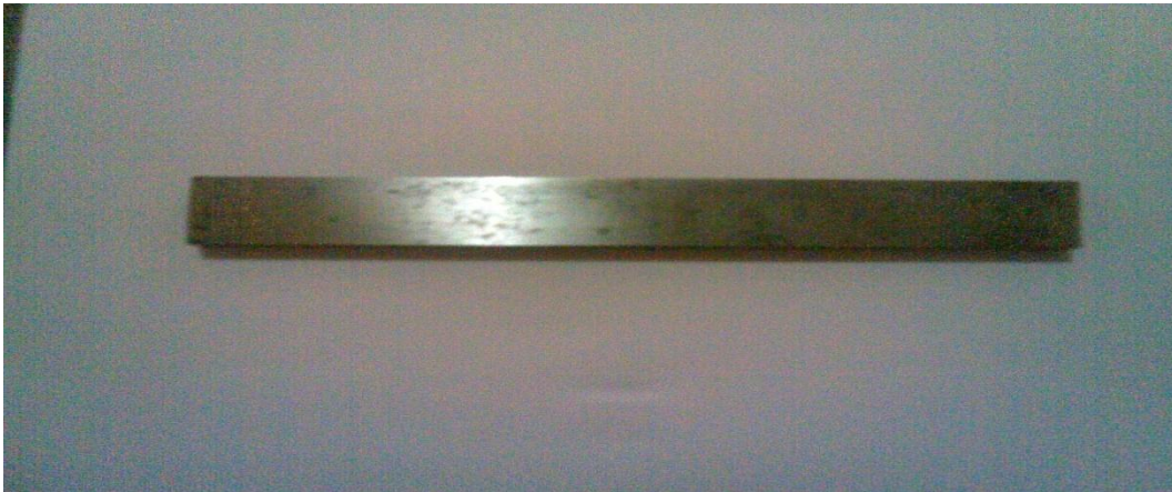
Figura III.1 Probeta para ensayos de indentación (Acero AISI 4140 (Q&T) sin recubrimiento)
