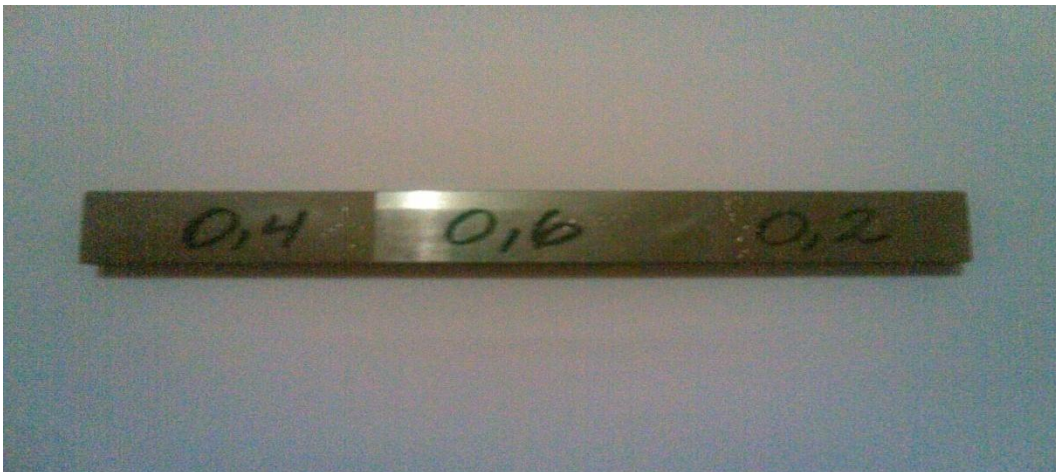
Figura III.2 Probeta para ensayos de indentación (Acero AISI 4140 (Q&T)/Aleaciones de Base Níquel)
