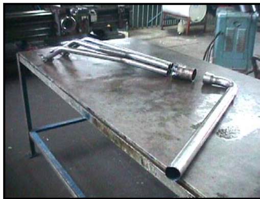
Ilustración 14. Configuración de conductos de escape 4-1.
