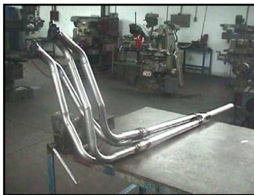
Ilustración 15. Configuración de conductos de escape 4-2-1.
