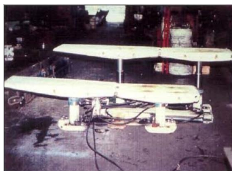
Figura N° 31. Entibación Autodesplazable Tipo Bloque. Fuente :Juarez (2003)
