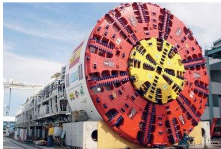
Figura N° 10. Tuneladora Herrenknecht EPB Shield S-300.
