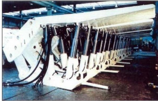
Figura N° 32. Entibación Autodesplazable tipo Bloque-Escudo. Fuente: Juarez (2003)
