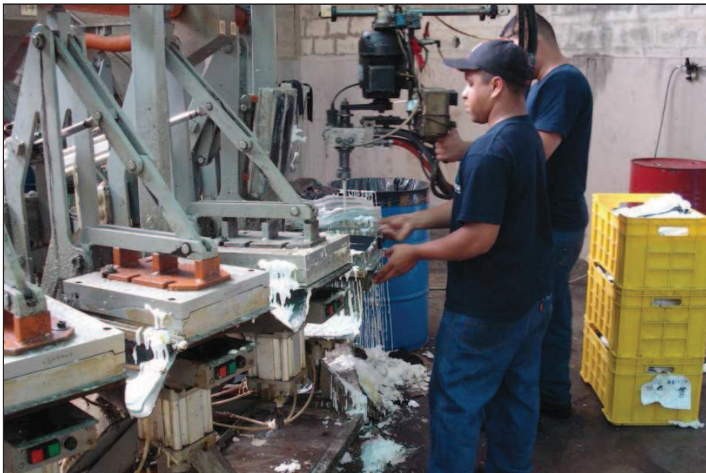
FIGURA 4.14 Operación de colada de poliuretano sobre cada molde. Se aprecia el exceso de material entre los moldes debido a la fuga que presenta la válvula durante su desplazamiento
