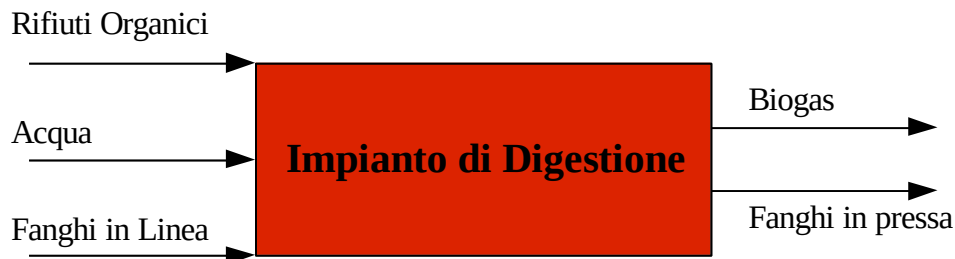
Figura 2.2: Disegno con gli entrati e uscite in massa dell'impianto .
