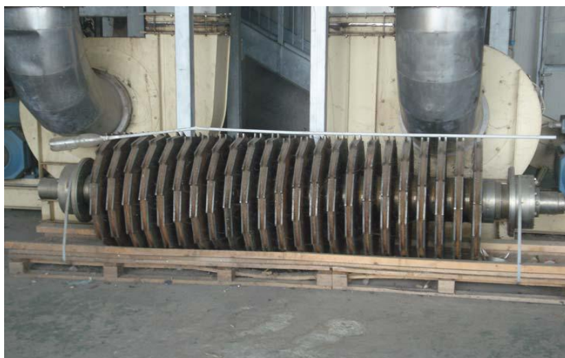
Figura 1.2: Particolare di uno dei due rulli lacerasacchi.
