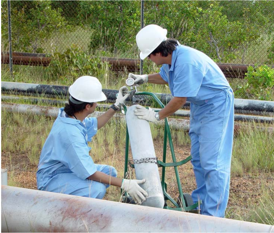
Figura 24. Toma de lectura de la presión de cilindro con gas del pozo GC4.
