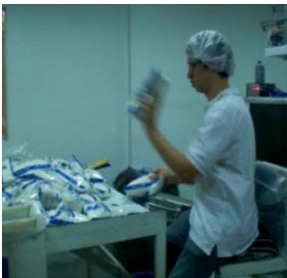
Transporte de bultos de 1 kg desde la salida de la máquina automática a la mesa de enfardado.
