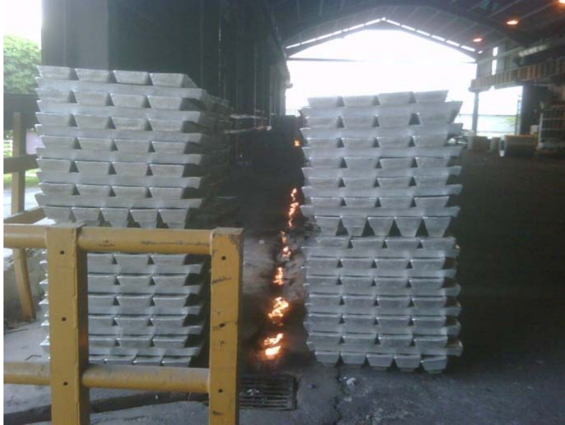
Figura 1.4. Zona de precalentamiento de los lingotes y pailas de Al primario.
