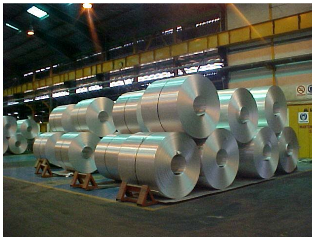
Figura 1.16. Rollos de aluminio sacados del proceso de Colada continua
