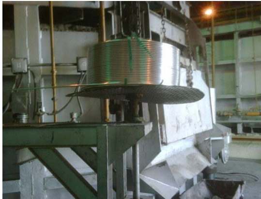
Figura 1. 7. inyección Titanio-Boro en forma de alambrón.
