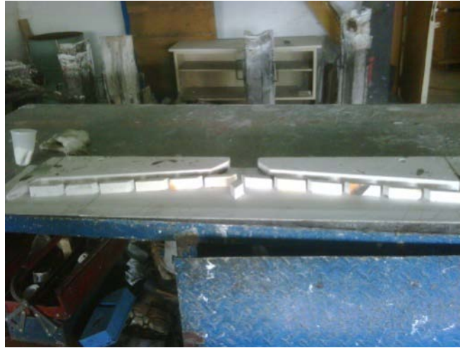
Figura 1.9. Pieza cerámica conocida como boquilla, forma de alimentación del metal líquido en los rodillos
