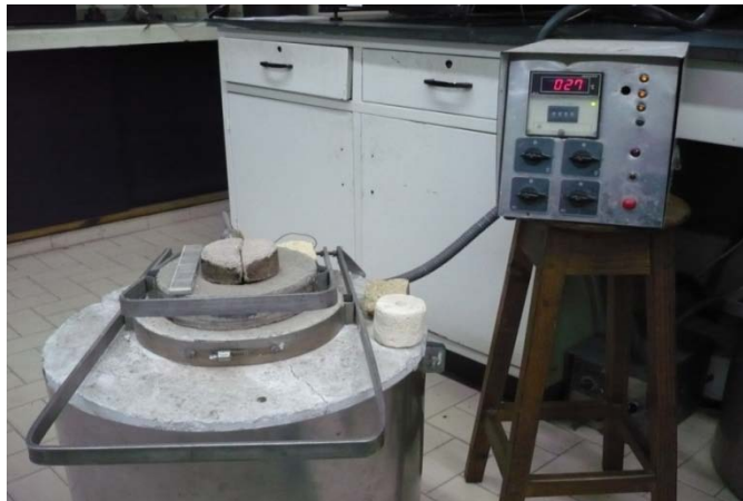
Figura 2.2 Horno de resistencia eléctrica para tratamientos térmicos.
