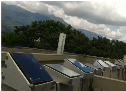
Fig. 5.0.1 Desalinizadores orientados hacia el sur.
