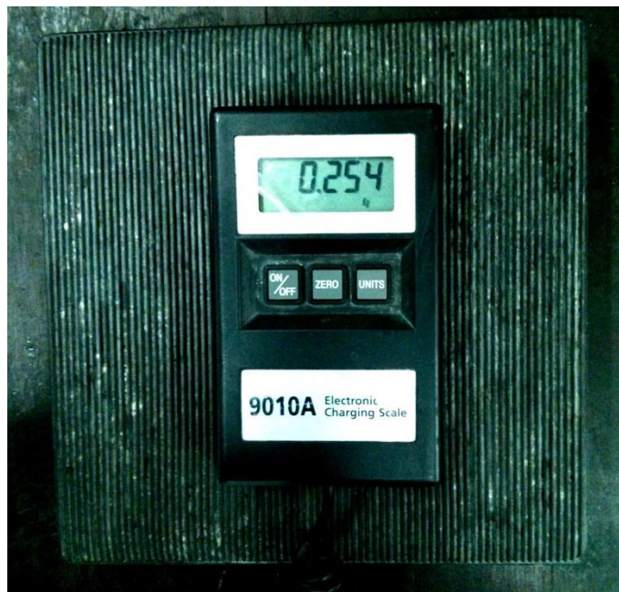
Fig. 4.0.1 Balanza digital usada para medir el condensado.
