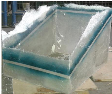
Fig. 3.0.9 Desalinizador después del desmoldado.
