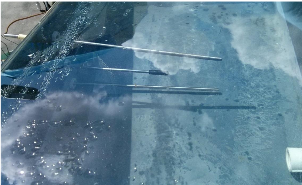
Fig. 4.0.2 Termocuplas ubicadas dentro de un desalinizador.
