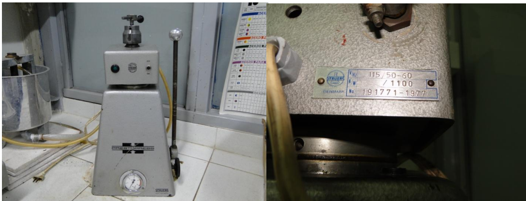
Figura 2.4 Embutidora PRESTOPRES Struers.
