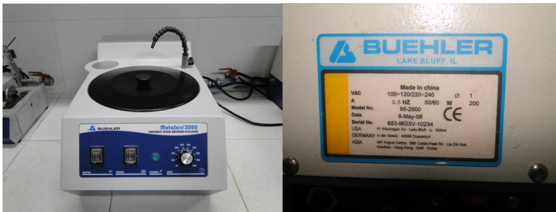
Figura 2.10 Pulidora marca BUEHLER, modelo metaserv 2000 variable “speed grinder-polisher”.
