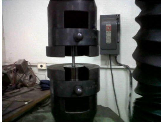
Figura 2.17 Montaje de la probeta en la máquina de ensayo de tracción.
