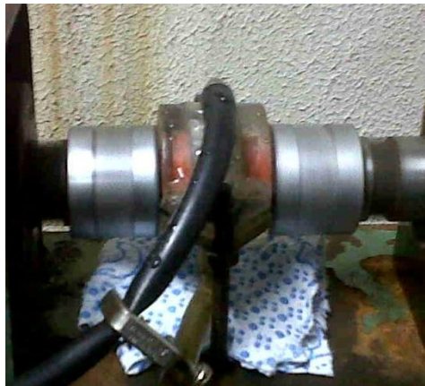
Figura 2.19 Capsula de acrílico, para generar condición de ambiente corrosivo.
