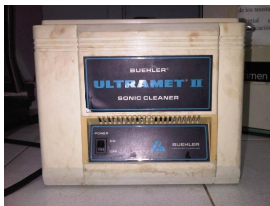
Figura 2.21 Equipo de limpieza por ultrasonido Buehler Ultramet II Sonic Cleaner.
