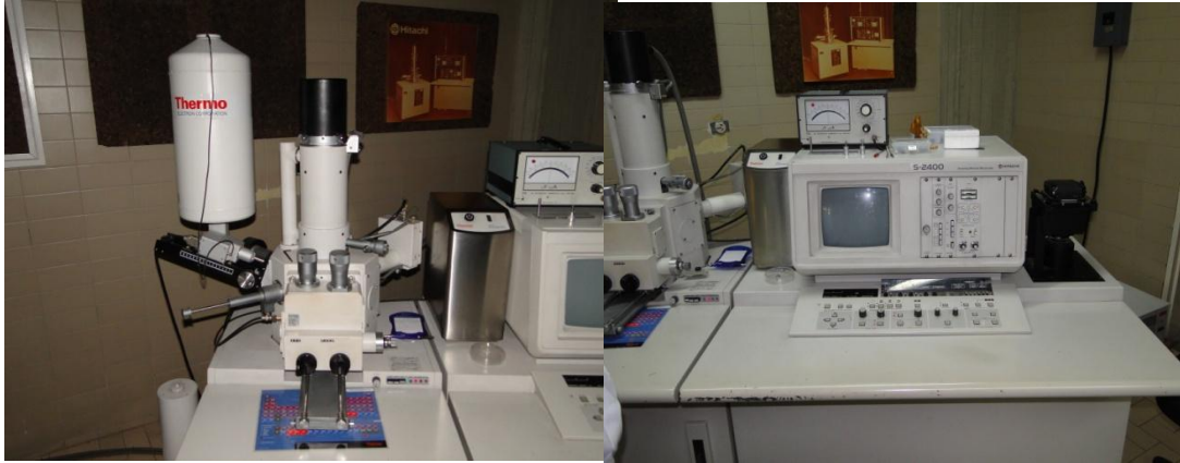
Figura 2.23 Microscopio Electrónico de Barrido Hitachi S-2400.
