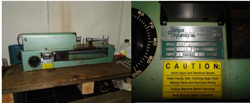
Figura 2.18 Máquina de fatiga “Fatigue Dynamics, RBF-200”.
