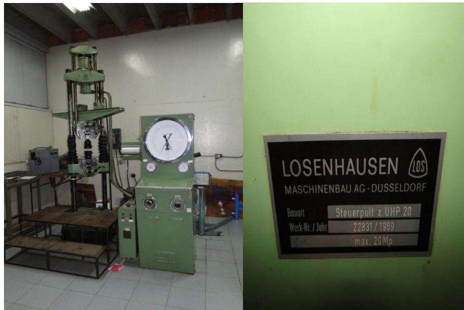
Figura 2.16 Máquina de ensayo de tracción Losenhausen, año 1969.
