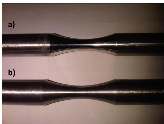
Figura 2.8 Probetas ensayo de fatiga en flexión rotativa, a) Espécimen pulido, b) Espécimen sin pulir.
